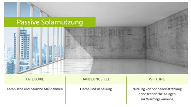
Durch die passive Nutzung von Solarenergie können ohne den Einsatz von technischen Anlagen solare Gewinne erzielt werden. Dies kann über unverschattete, große Fenster mit Südausrichtung, Wintergärten oder transparente Wärmedämmung der Gebäudehülle sowie die konsequente Ausrichtung des Gebäudes erreicht werden.
